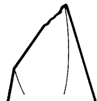
刃先が摩耗しています
